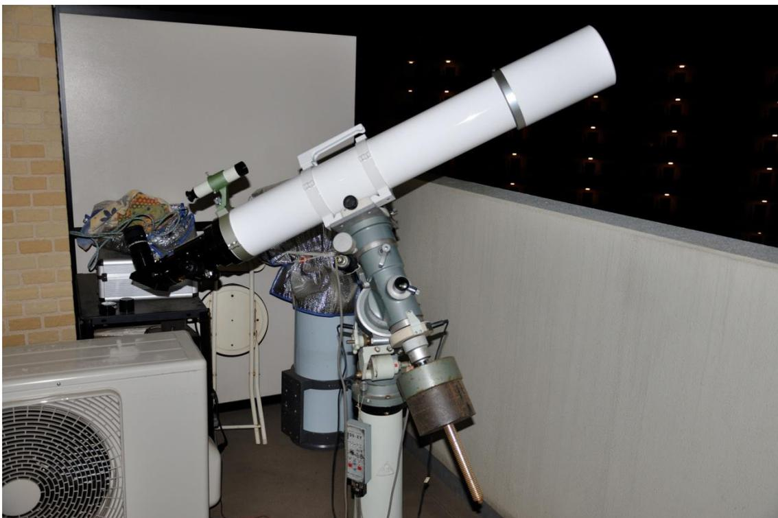
自宅での運用はタカハシの 160JP で行っています。さすがに大きいので、これくらいの赤道儀がしっかりして見えました。ウェイトは標準の 6.5kg に加えて 12kg のものをつけて最上部でバランスしています。標準ウェイト 2 個で十分調整できる範囲です。
